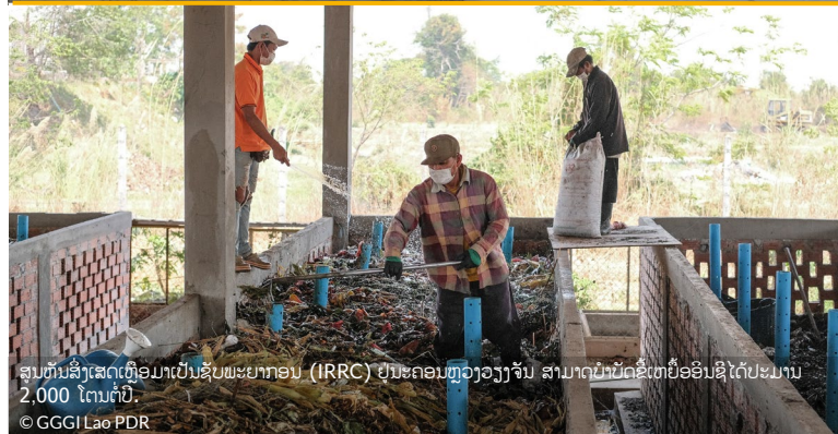
ໂຮງງານບໍາບັດຂີ້ຕະເລດອາຈົມ ຢູ່ ນະຄອນປາກເຊ ທີ່ມີຂີດຄວາມສາມາດໃນການຮອງຮັບຂີ້ຕະເລດອາຈົມ 25 ແມັດກ້ອນ/ວັນ. © GGGI Lao PDR
